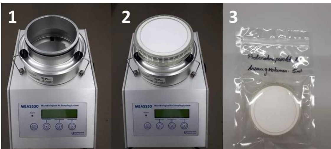
Abbildung 9: indirekte Luftprobenahme - Filtration und Verdünnung
