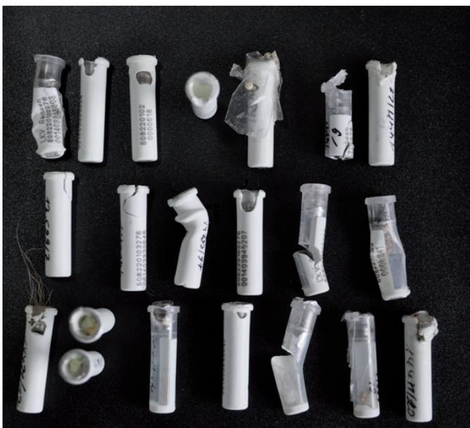
Abb. 3: „Defekte“ Ohrstanzcontainer
