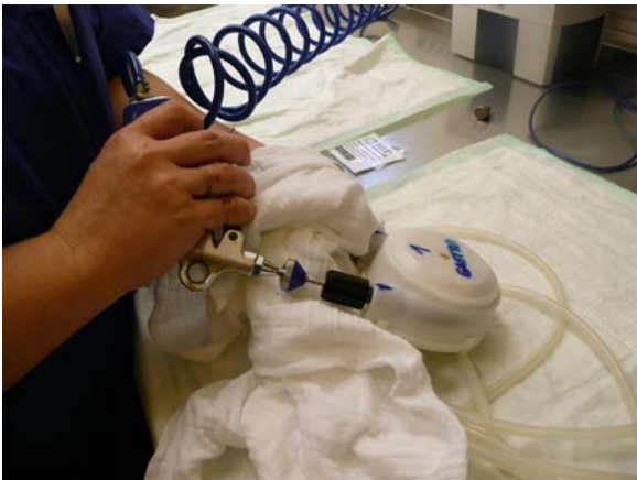
Abb. 7: Prüfung auf Trockenheit der Fördereinheit
