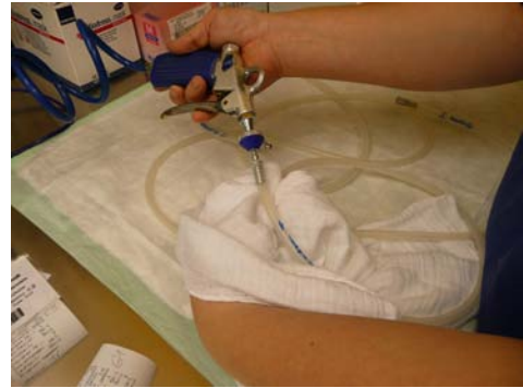
Abb. 8: Prüfung auf Trockenheit der Schläuche
